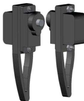
Фиг.17. Огледална симетрия при сглобяване на тибийте
