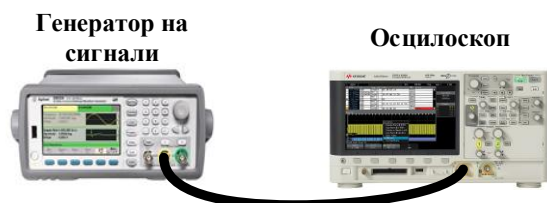
Фиг. 3. Схема за измерване на АМ
