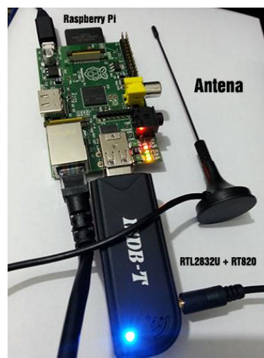
Фиг. 2. Хардуерна реализация на SDR-базирания платформа
