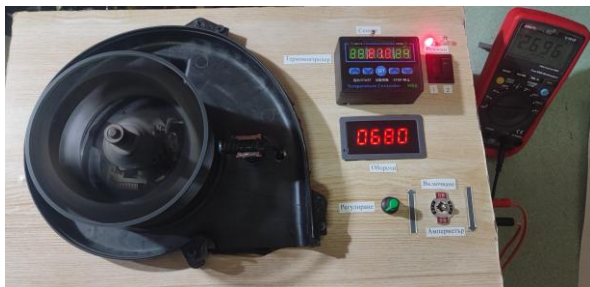
Фиг.6. Макет за измерване на оборотите на постояннотоков електродвигател.
