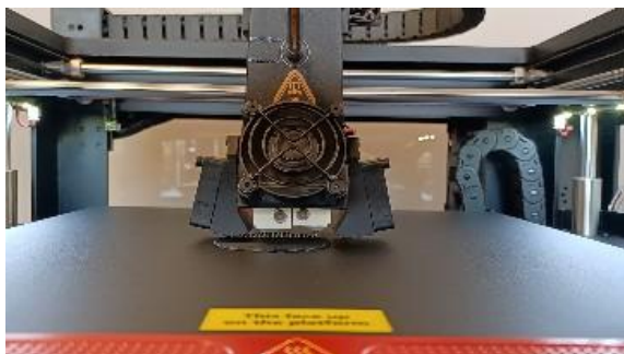
Фиг. 2. 3D принтер с двойна екструдерна система
