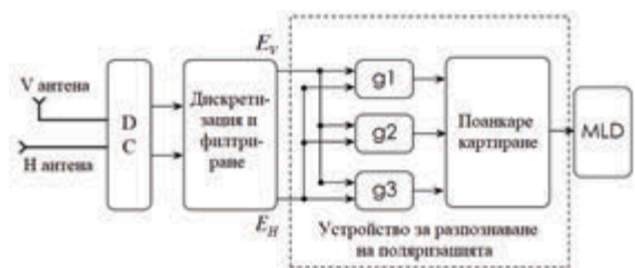
Фиг. 5. Приемник на поляризационно модулирани сигнали
