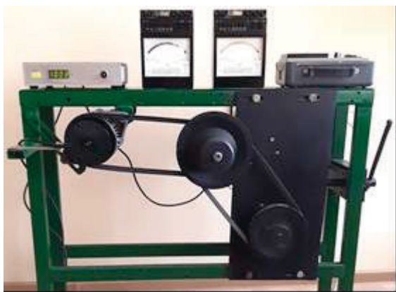
Фиг. 4. Общ вид на лабораторна установка за изследване на клинооремъчен вариатор
