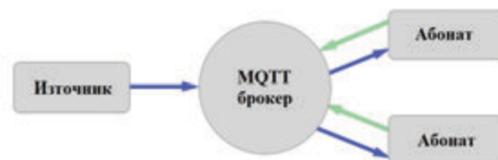
Фиг. 1. Архитектура на MQTT протокол
