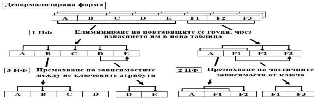
Фиг. 1.1 Примерен процес на нормализация до трета нормална форма
