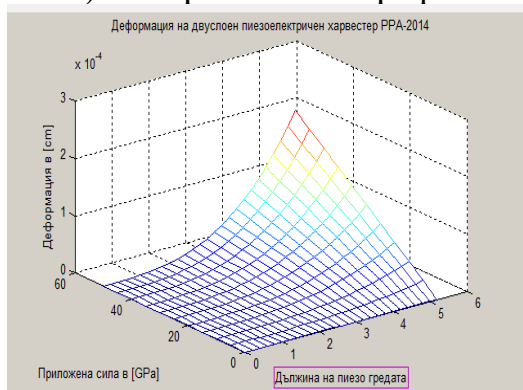
Фиг. 2.9 Деформация на двуслойна гредата PPA- 2014
