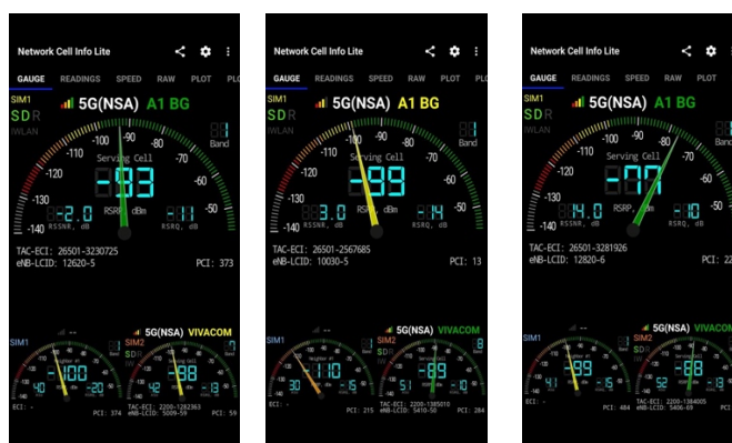
Фиг.4.76. Сила на сигнала, информация за обслужващата клетка, за съседните клетки и втората SIM карта
