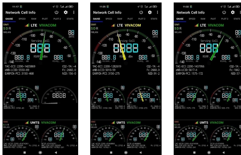
Фиг.4.37. Сила на сигнала, информация за обслужващата клетка, за съседните клетки и втората SIM карта
