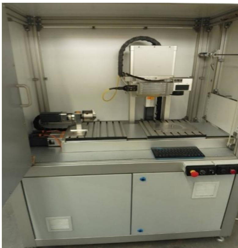
Фиг.2.3. Общ вид на установката за лазерно маркиране на слоесто армирани композити с полимерна матрица
