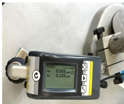
Фиг.3.5.Схема на измерване на грапавост по критерия, R_a, \mu\text{m} .
