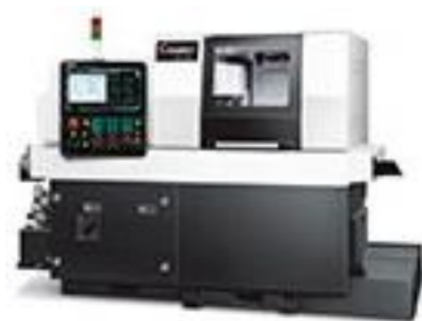
Фиг.3.1. Общ вид на CNC стругов център швейцарски тип модел GOODWAY SW-20 [136]
